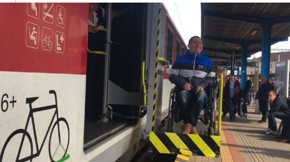
• Elektrická plošina umožní jednoduché nastupovanie do vlaku. (Autor: Daniel Šmid)
